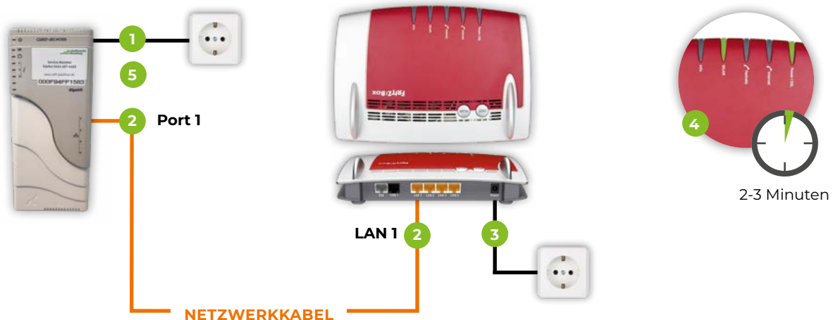
Netzabschlussgerät (ONT, z. B. GENEXIS-Box)
